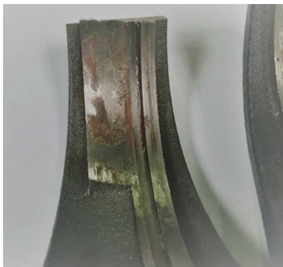
图1：风机轴承外圈刮痕显示OnSite在线状态监控系统所检测到的各种缺陷
