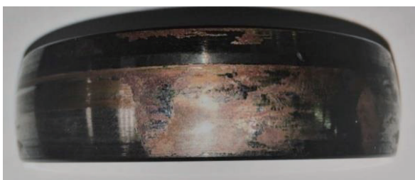
图9：拆卸后轴承剖分图显示内圈（底部）和外圈（顶部）均出现可见的损坏迹象。
