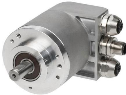
Profinet 定义了 RT 模式  $< 10\text{ms}$ 、IRT 等时同步模式  $< 1\text{ms}$ ，采用优先级的方式处理通信转发规则。由于编码器属于高速位置反馈设备，为了保证数据传输的实时性，我们强烈建议使用支持 IEEE802.1P 协议的交换机实现 RT 模式高速数据传输。如果需要最精准的同步效果，需要配合西门子搭载 ERTEC 芯片的交换机来实现最佳同步效果。
